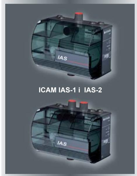
Vazduh se uzorkuje iz štićenih područja kroz jednu ili dve ulazne cevi i tada prolazi kroz interni filter vazduha (u kertridžu) do jednokanalnog ili dvokanalnog kontrolera. Senzori smešteni u kontroleru mogu biti konvencionalni ili analogni detektori dima, vaši ili naši (pogledajte uputstvo za više informacija). Vlasnici ekskluzivnih rezidencijalnih objekata izuzetno ih cene zbog njihove diskretne estetike i prilagodljivosti prostoru..
