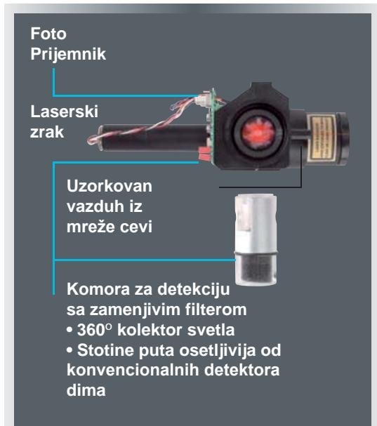
Optika ICAM instrumenta je zaštićena čvrstom zamenjivom optičkom komorom sa ugrađenim filterom koji omogućava zamenu i servis na licu mesta i u najprljavijim okruženjima.
